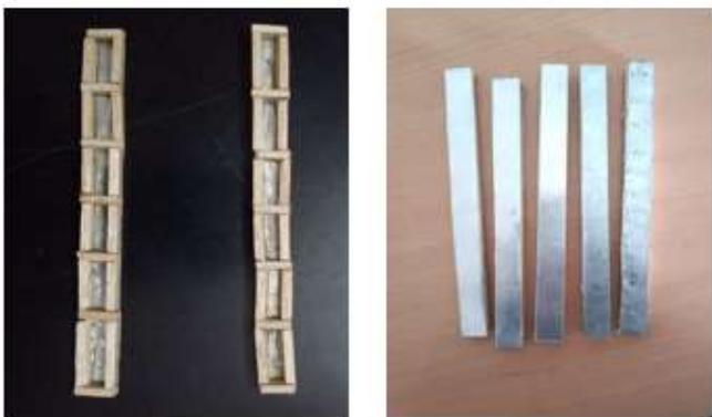
Fig.2.1. Tensile test specimen
