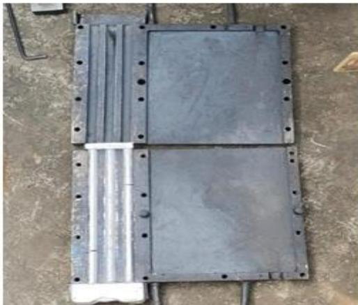
Fig 3: Ingots in die
